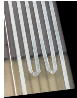
So wie oben sieht das Prinzip in der Praxis aus. Wie der Heizfaden auf der Autoheckscheibe kringelt sich der schmale Aluleiter über die Folie
